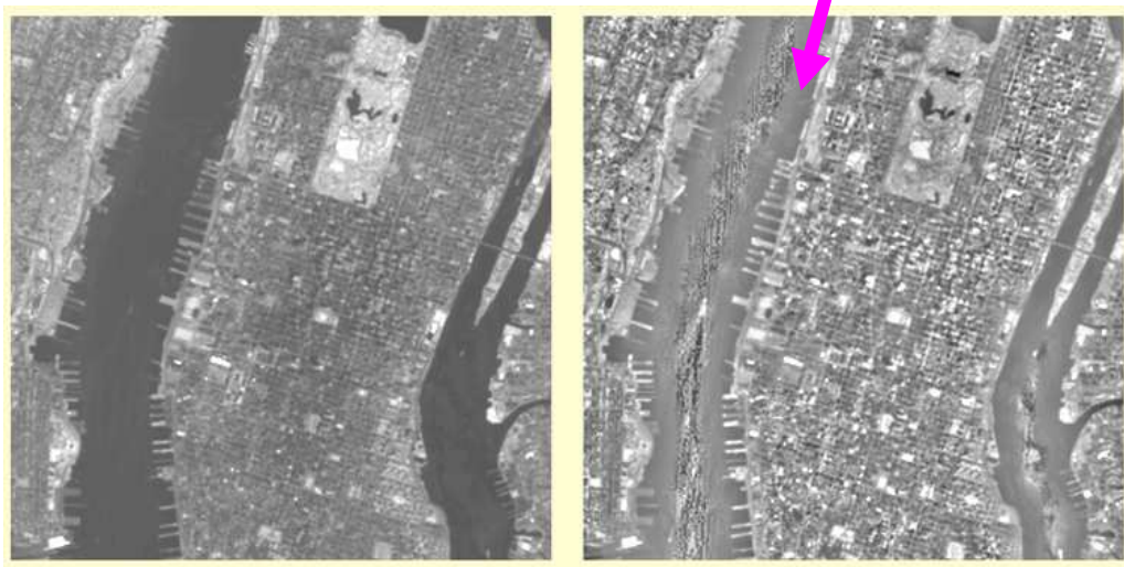
fig. 1 - Image SPOT de New-York – Original (gauche) – Stretching linéaire local ( \bar{m}_0=128 , \sigma_0=40 , s=31 ).
