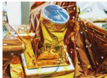
Système de localisation stellaire (star tracker) de SPOT5
