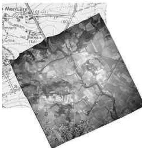
**Figure X.1.** *Vue aérienne orthorectifiée superposée à une carte (Courtoisie TTI Productions).*
