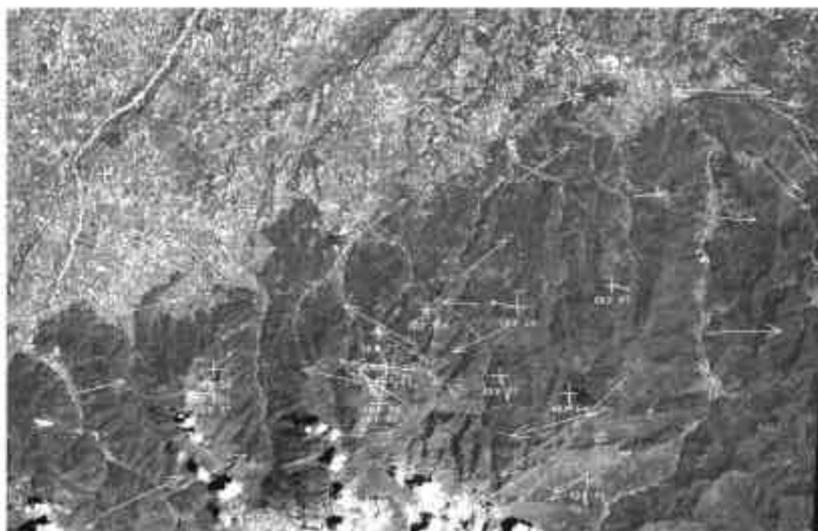
**Figure X.11.** Défauts de correction des parallaxes en zone montagneuse.
